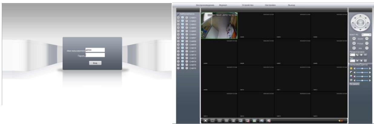
**Примечание:** для работы с видеорегистратором на мобильном телефоне через браузер, введите IP-адрес устройства. Например, если IP-адрес видеорегистратора 192.168.1.157 и его веб-порт 8099, введите в адресной строке браузера <http://192.168.1.157>:8099. Далее введите логин и пароль. Для просмотра другого канала, нажмите кнопку "возврат" и выберите другой номер канала на странице настроек.
