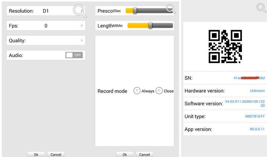
«Record» - установка предзаписи и длины записи одного файла видео.
